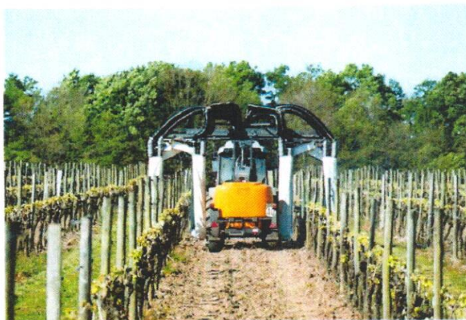
Fig. 6. Mașină de tratamente fitosanitare cu ecrane pentru recuperarea surplusului soluției de stropit, Gregoire Ecoprotect
